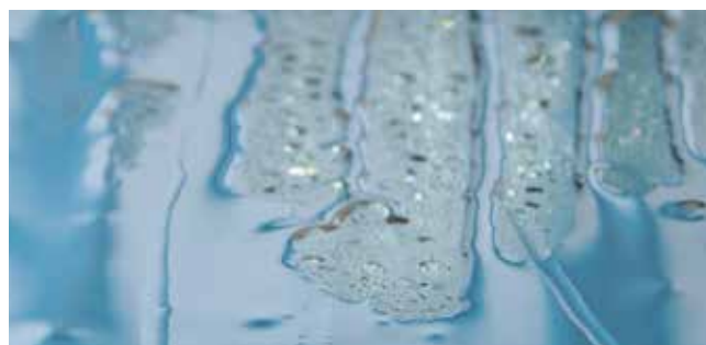
Ūdens iedarbība uz stiklu, kas nav pārklāts ar AntiCalc® slāni
